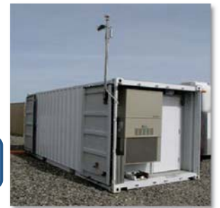
移動型希ガス観測装置 (TXL : Transportable Xenon Laboratory) 11
